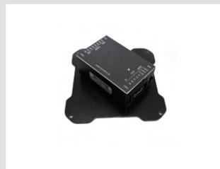
独自開発のフライトコントローラーにより、高い安定性と操作性を実現。精密な飛行制御で、正確な農薬散布を可能にします。
